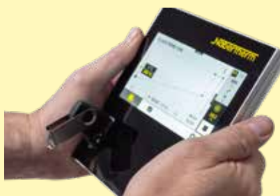
Zaznamenávání procesních dat připojeného kontroléru pomocí USB flash disku
