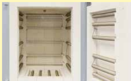
Vyhřívání z pěti stran a speciální uspořádání topných článků pro optimální rozložení teploty
