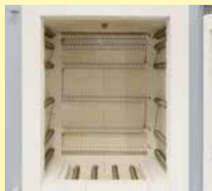
Ötoldali fűtés és a fűtőelemek speciális elrendezése az optimális hőeloszlás érdekében
