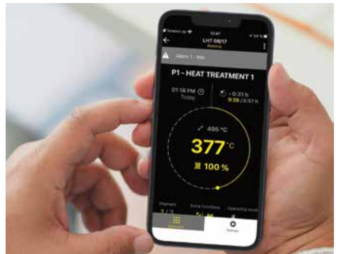
Az alkalmazás által küldött (push) értesítések hibáüzenetek esetén
