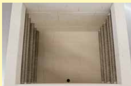
Elementy grzewcze na rurach nośnych zapewniają swobodne promieniowanie ciepła
