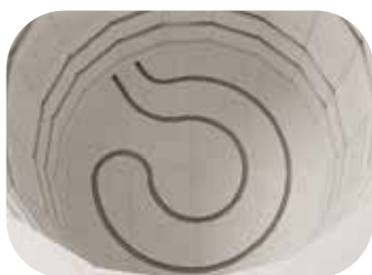
Ogrzewanie dna i ręczna regulacja strefowa dla pieców większych niż 80 litrów:
