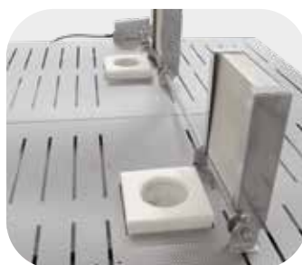
Clapetă de eşapament cu comandă motorizată pentru răcirea accelerată a cuptorului după arderea finalizată
