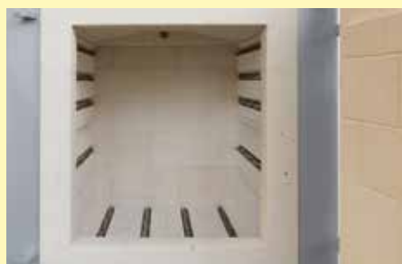
Încălzire pe trei fețe prin elemente de încălzire protejate în caneluri
