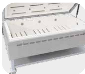
Mese pentru extinderea sistemului de cuptoare pentru modelele GFM; sistem cu schimbare a meselor pentru utilizarea căldurii reziduale a cuptorului și pentru reducerea duratelor de ciclu prin schimbarea meselor în stadiul încă cald.
