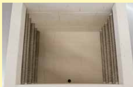
Elementele de încălzire de pe tuburile de susținere asigură o radiație liberă a căldurii
