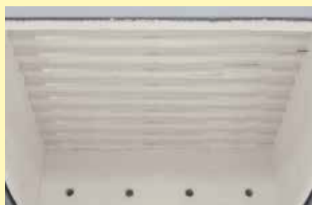
Elementele de încălzire ale tavanului dispuse aproape unul de altul, protejate în tuburi de sticlă de cuarț
