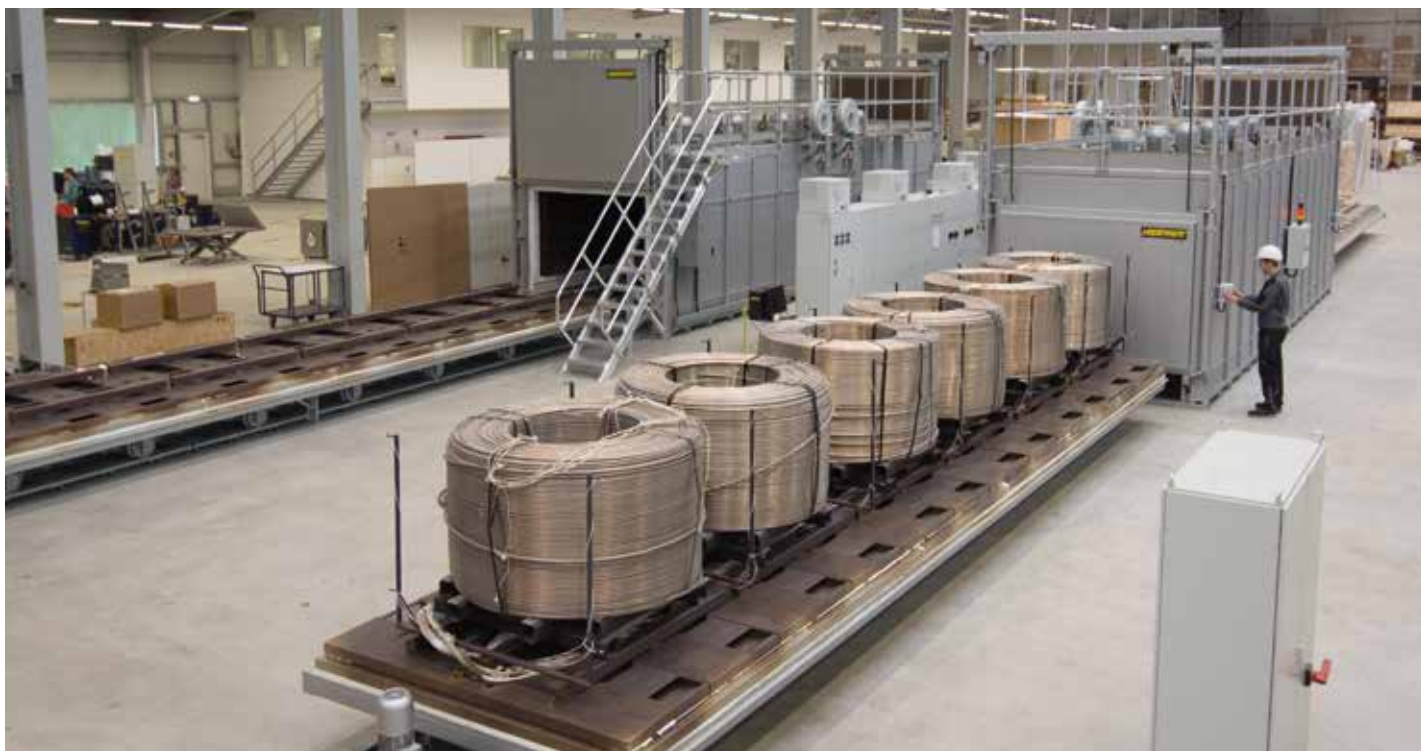
Four à sole à bogie à convection forcée W 24750/60AS pour le recuit de bobines d'aluminium
