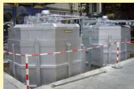
Fours puits à convection forcée SAH 5600/75 S dans la production
