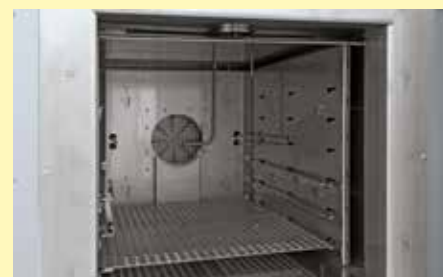
Intérieur avec tablette en tôle, thermocouples et surveillance de la pression
