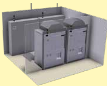
Four haute température avec chargement depuis la salle blanche; Armoire électrique et four installés en salle grise
