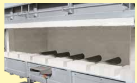
Énergie gaz indirecte à tubes de radiation
