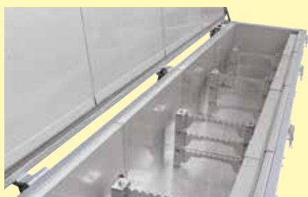
Support de charge pour de longs tubes dans un four à couvercle à convection forcée SAL 750/08
