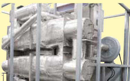
Echangeur thermique à contre-courant sur le four chambres à convection forcée N 2560/26 ACLS
