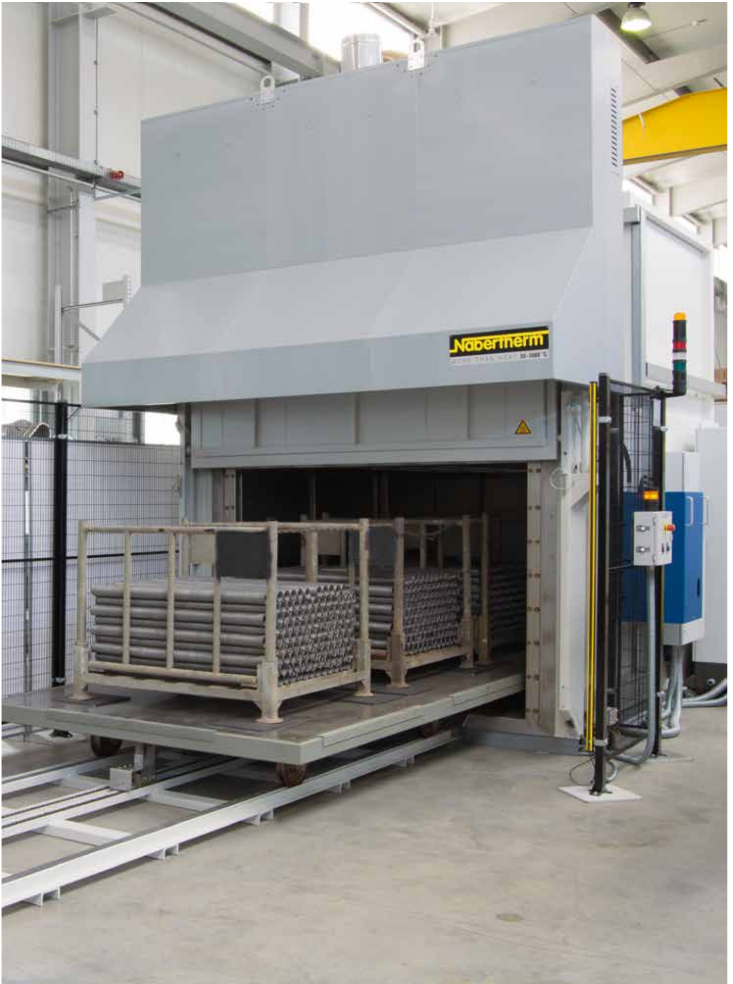
Four chambre à convection forcée avec chauffage direct au gaz NB 10080/26HAS équipé d'un chariot de chargement piloté.
