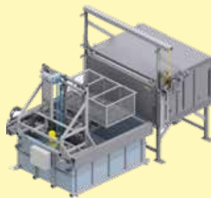
Installation de trempé et revenu automatique pour le verre
