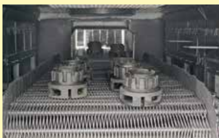
Convoyeur à mailles métalliques dans un four continu
