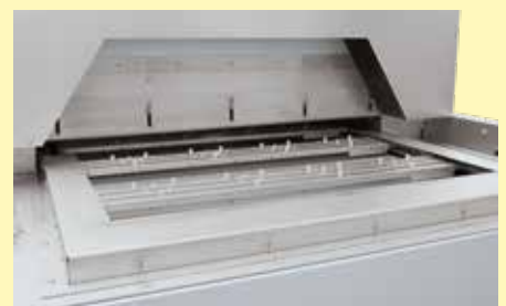
Four continu D 1000/1250/200/26AS pour l'attrepage de pièces moulées par injection
