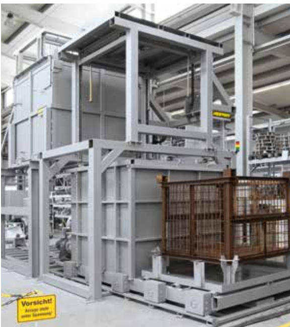
Installation de four vertical entièrement automatique avec grue de déchargement (variante B)
