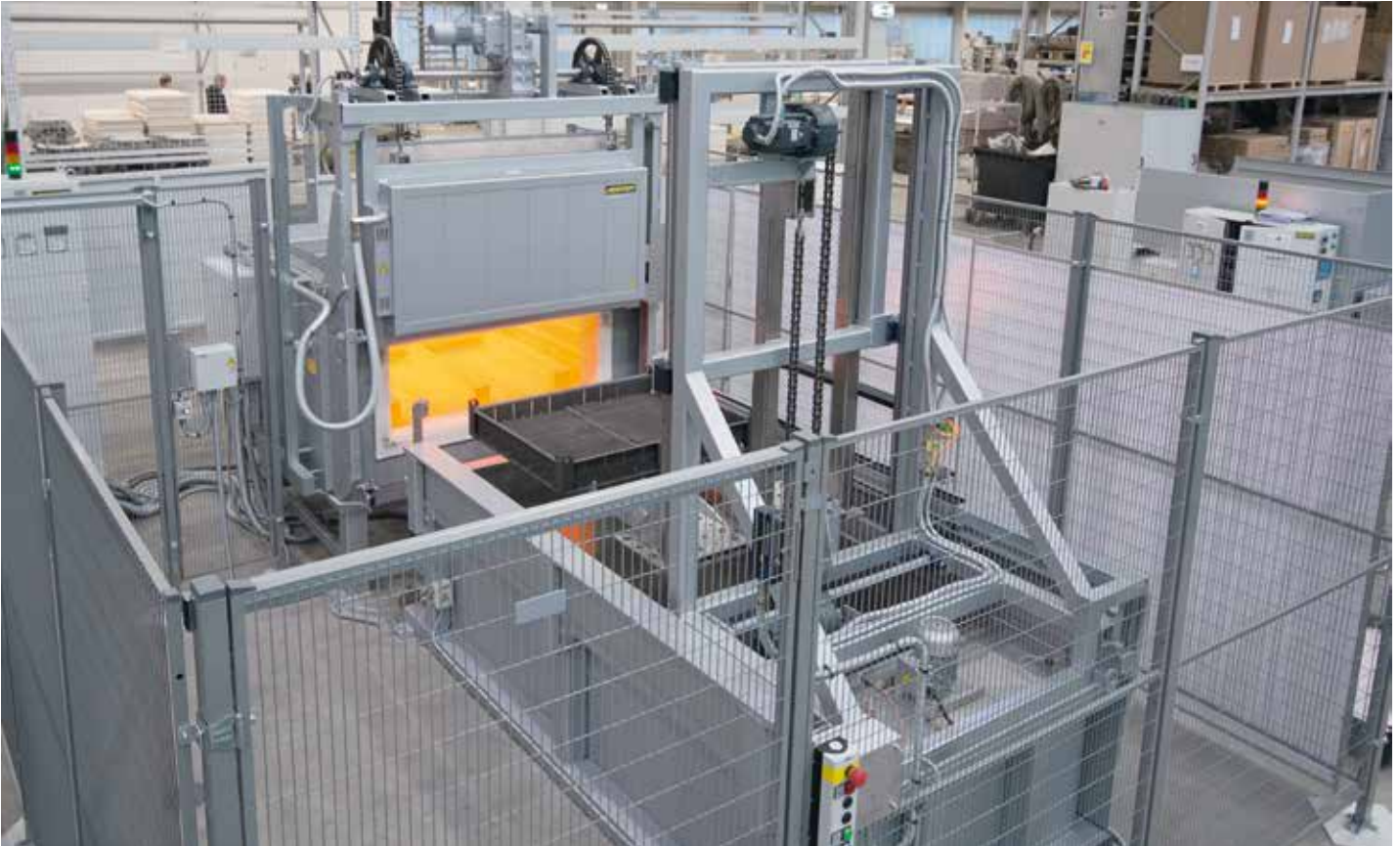
Installation de trempé et de revenu entièrement automatique composée d'un four de recuit, d'un bac de trempé à l'eau et d'un manipulateur à deux axes
