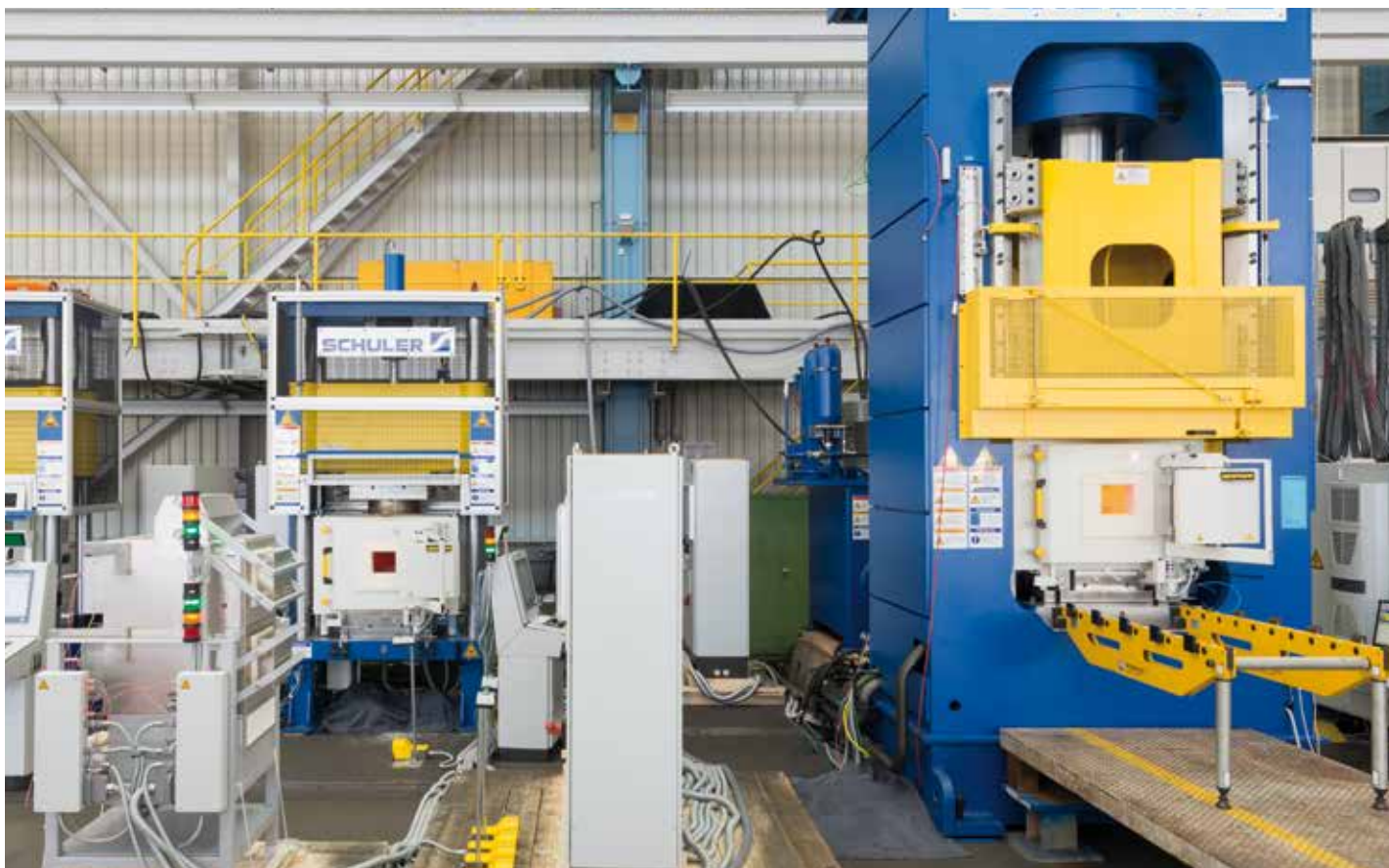
Four de préchauffe de matrice de presse pour installation de forgeage à chaud
