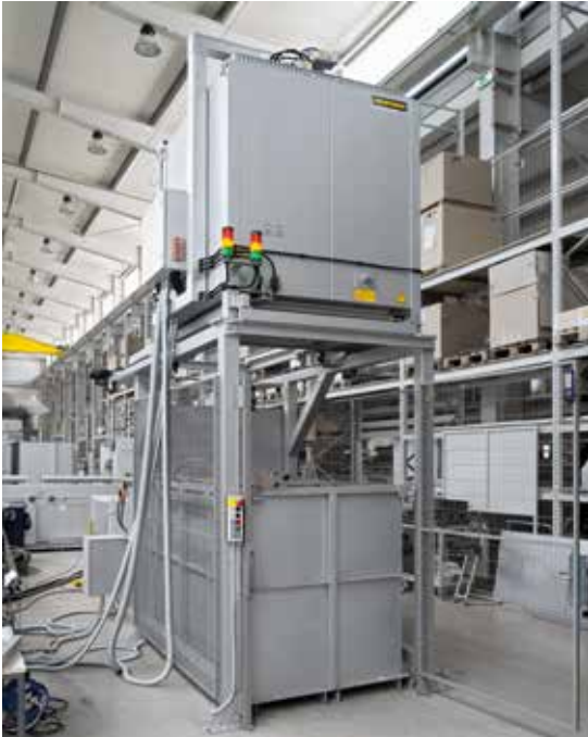
Installation de four vertical avec bac de trempe fixe (variante A)
