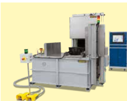
Installation de trempé et revenu semi-automatique pour l'aluminium
