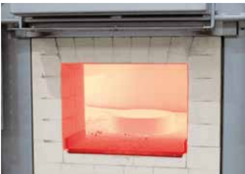
Préchauffe de cercles d'acier pour le forgeage dans le four à sole rotative
