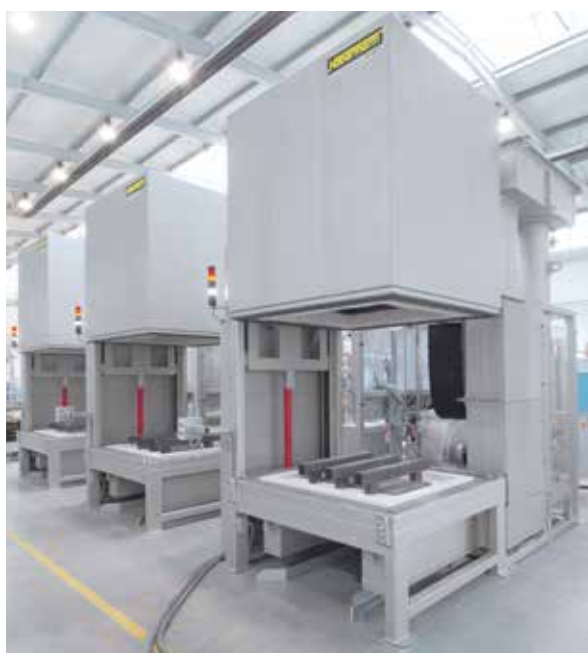
Installation de production comprenant 3 fours cloche HAS 1560/95S avec carrosse étanche au gaz pour un fonctionnement à l'azote. Inclus un échangeur de chaleur air/gaz pour raccourcir les temps de refroidissement
