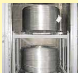
Transfert de chaleur entre charge à l'état chaud et charge à l'état froid
