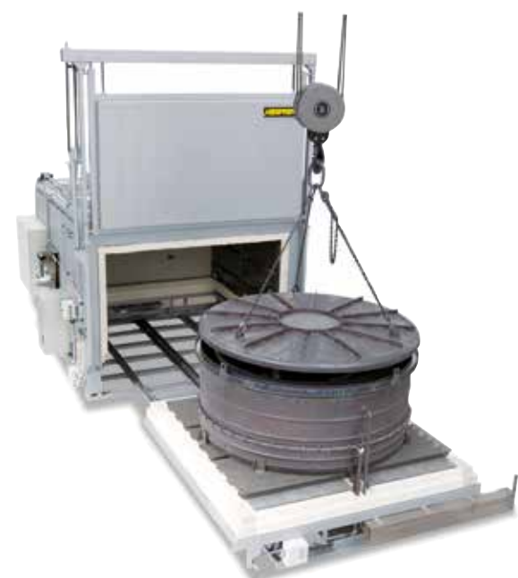
Four sole mobile à circulation d'air W 5290/85AS avec caisson de recuit. Traitement thermique de bobines sous balayage de gaz neutre.
