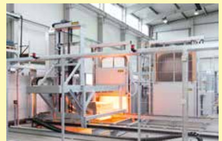
Installation de trempé et revenu automatique pour l'acier
