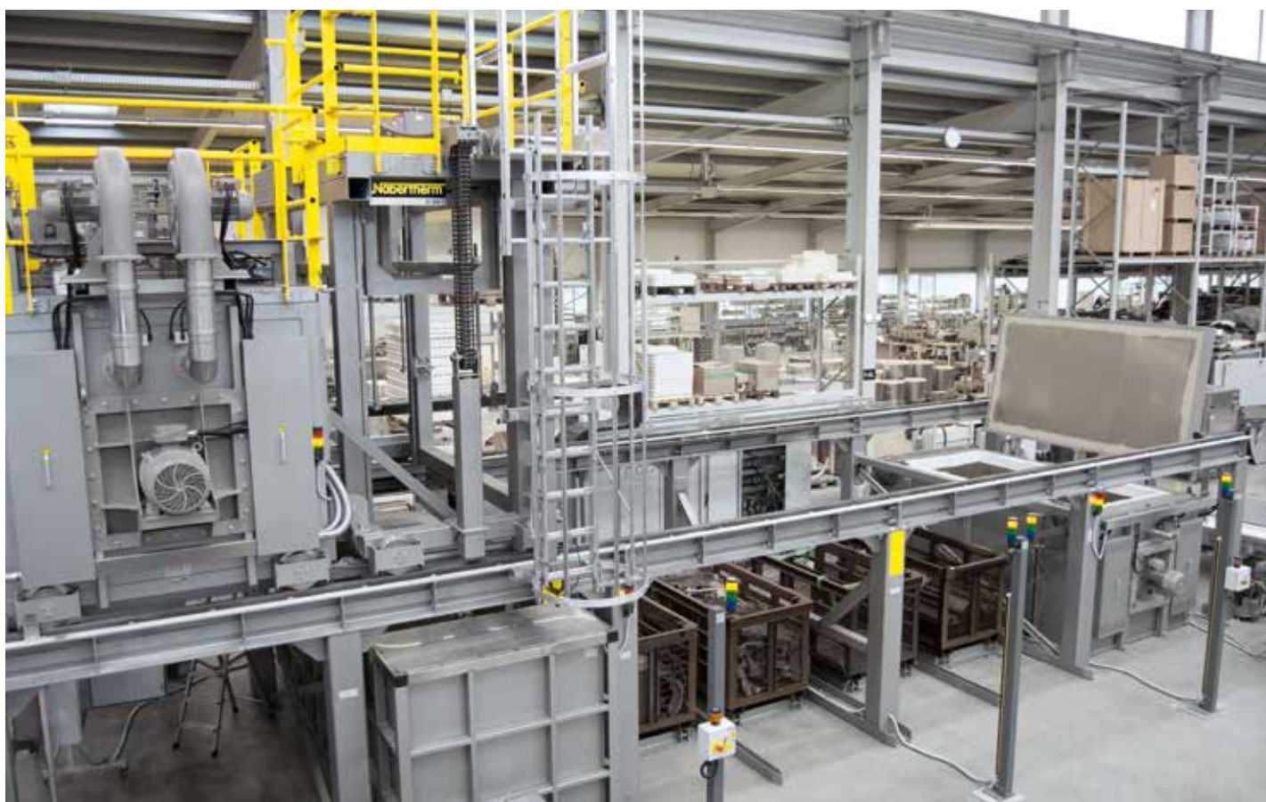
Four vertical mobile pour le recuit de mise en solution avec four puits pour le vieillissement à chaud avec quatre emplacements
