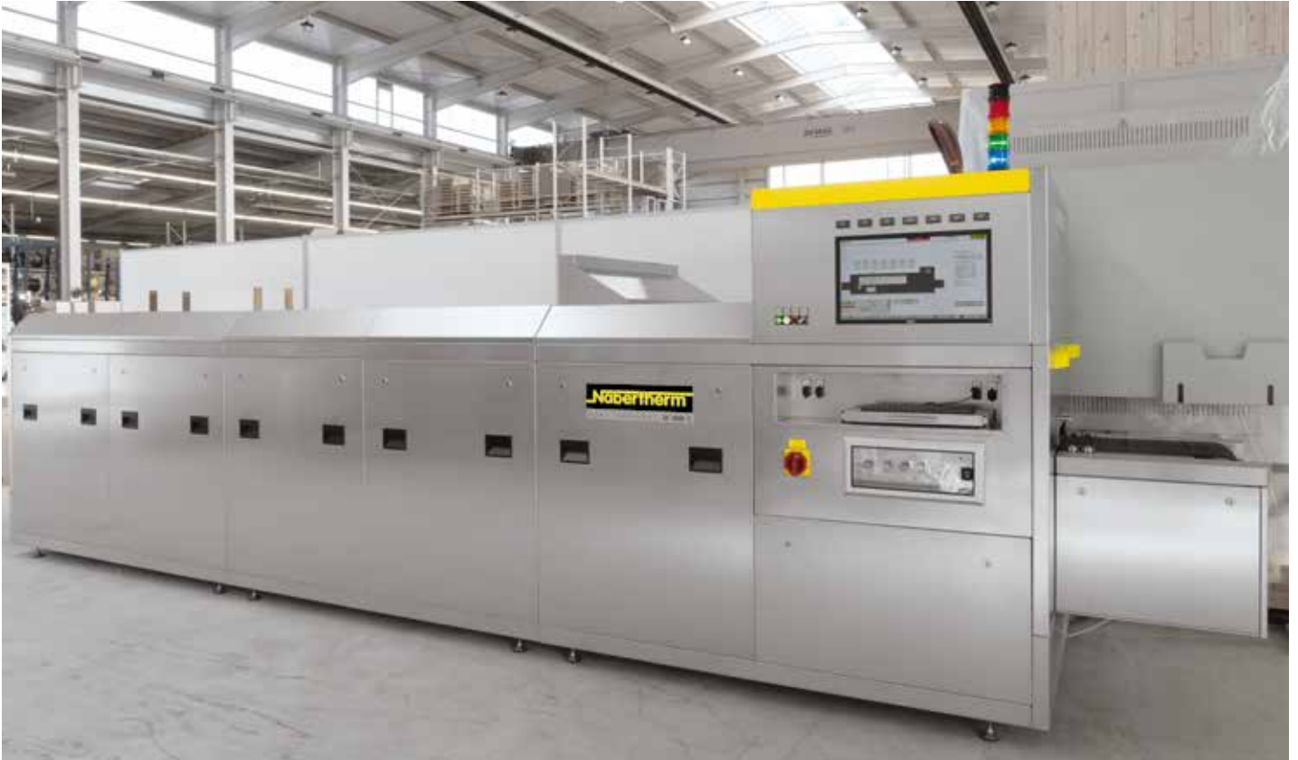
Four continu DF 36/320/5/10WK pour le brûlage et la cuisson/frittage dans les applications LTCC.
