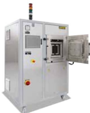
Four moufle étanche à paroi froide VHT 8/16 MO pour le déliantage résiduel et le frittage consécutif de pièces métalliques après l'impression 3D
