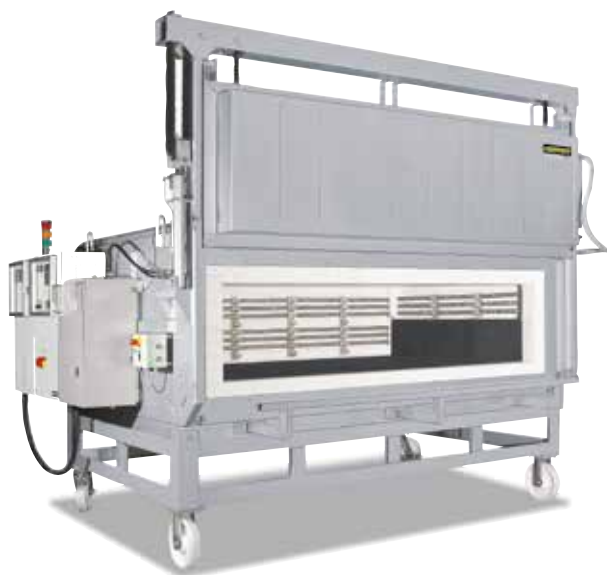
Four chambre avec porte guillotine électro-hydraulique, socle sur roulettes, pour le préchauffage de tôles de grandes dimensions pour l'industrie automobile.
