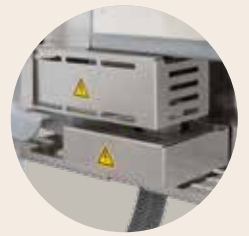
Türkontaktschalter geschützt montiert
