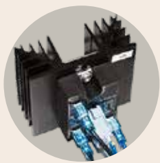
Geräuscharme Schaltung der Heizung über Halbleiterrelais
