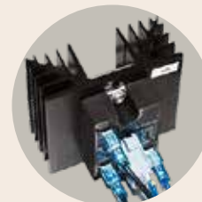
Geräuscharme Schaltung der Heizung über Halbleiterrelais
