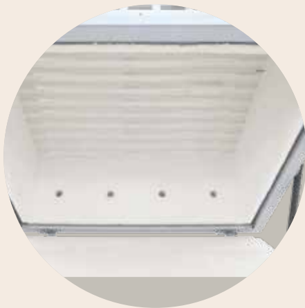
Dicht nebeneinander angeordnete Deckenheizelemente, geschützt in Quarzglasrohren
