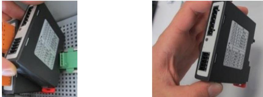
Abb. 10: Ausbau der Reglermodule – Teil 2 (Abbildung ähnlich)
