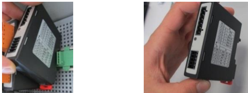
Fig. 10: Demontarea modulelor controlerului – Partea 2 (Figură similară)
