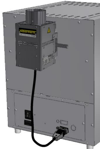
Abzugskamin mit Ventilator , um entstehende Abgase besser aus dem Ofen herauszuführen. Mit Controller B510 – P580 programmabhängig schaltbar (nicht bei Modell L(T) 15.., L 1/12, LE 1/11, LE 2/11)*.
