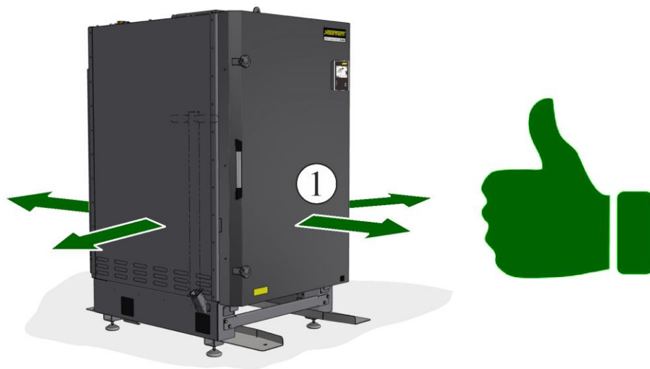
28. ábra: Kemence lerakása és pozicionálása (az ábrán láthatóhoz hasonlóan)
