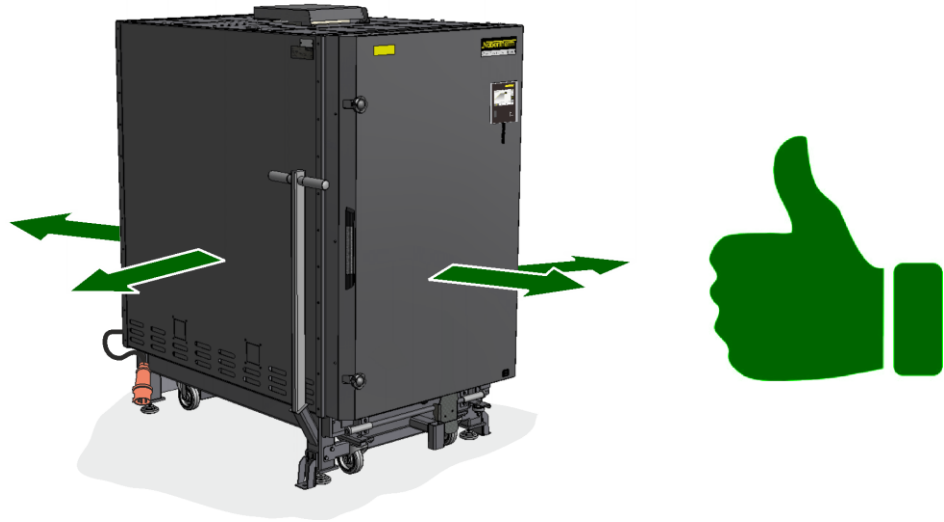
38. ábra: Kemence lerakása és pozicionálása (az ábrán láthatóhoz hasonlóan)
