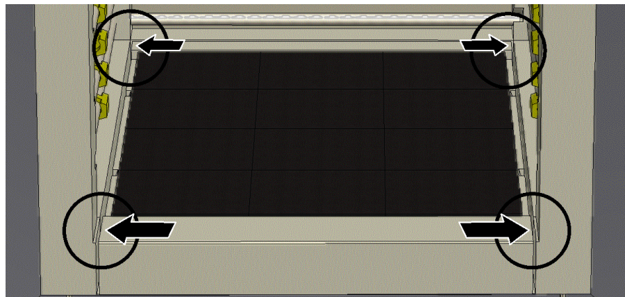
36. ábra: Magasság ellenőrzése a teljes hosszban (az ábrán láthatóhoz hasonlóan)
