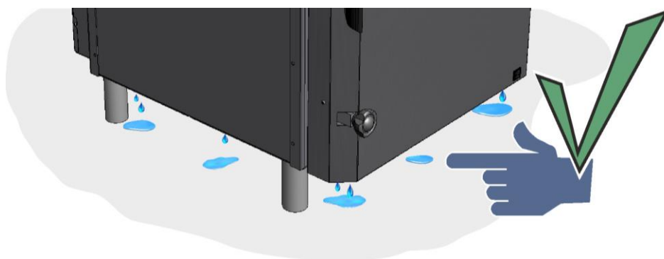
67. ábra: Kondenzvíz összegyűlése az első égetések alatt (az ábrán láthatóhoz hasonlóan)
