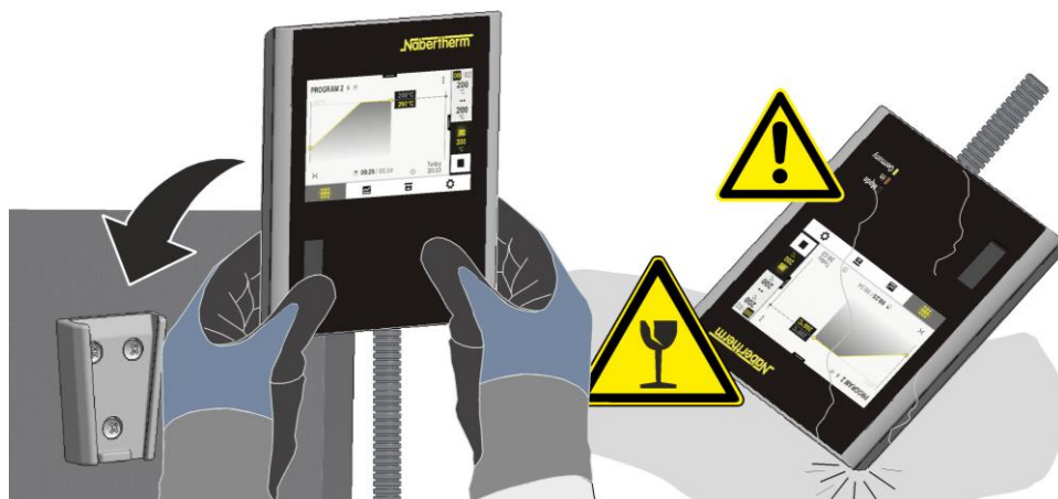
71. ábra: A vezérlőt a kemencén található tartóban kell használni (az ábrán láthatóhoz hasonlóan)
