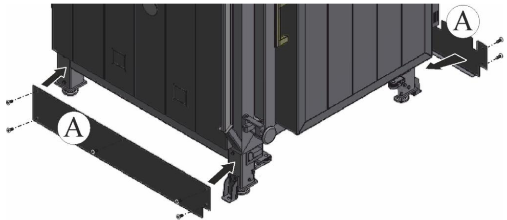
46. ábra: Az oldalsó lemezek felszerelése (az ábrán láthatóhoz hasonlóan)
