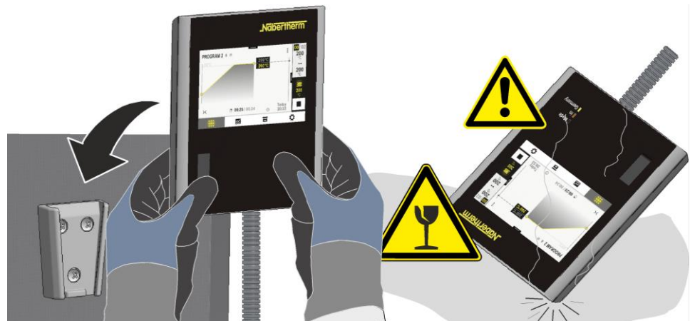
55 ábra: A vezérlőt a kemencén található tartóban kell használni (az ábrán láthatóhoz hasonlóan)
