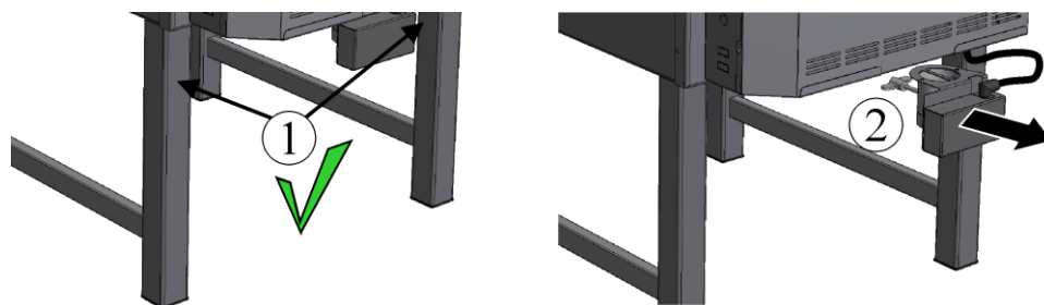
Obr. 52: Vytiahnutie klapky privádzaného vzduchu z držiaka (podobne ako na obrázku)
