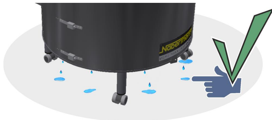
Obr. 67: Hromadenie kondenzátu počas prvých výpalov (podobne ako na obrázku)
