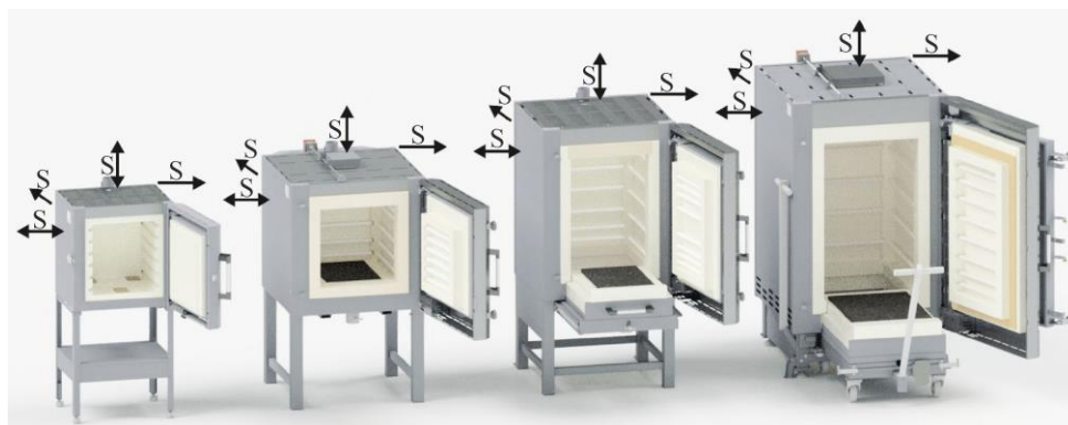
Obr. 17: Minimálny bezpečnostný odstup od horľavých materiálov
