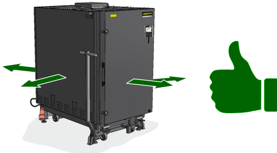
Obr. 38: Spustenie a polohovanie pece (podobne ako na obrázku)
