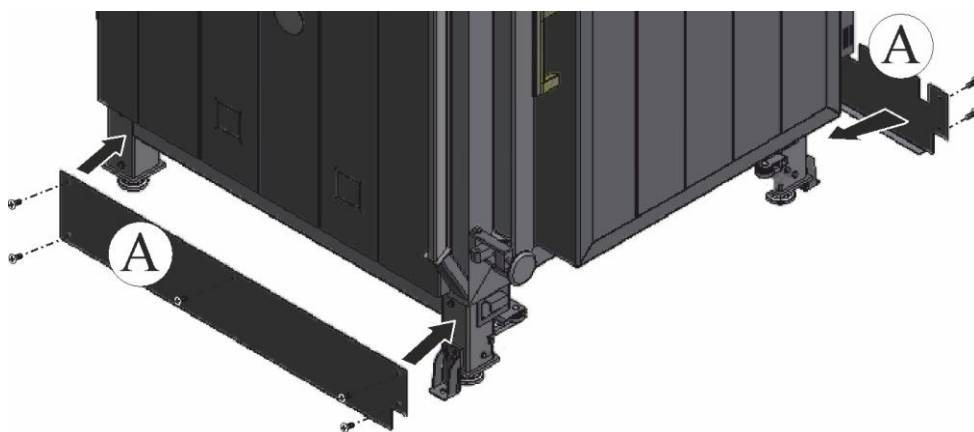
Obr. 46: Montáž bočných plechov (podobne ako na obrázku)
