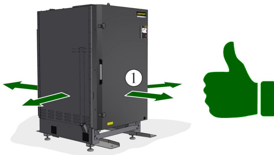
Obr. 28: Spustenie a polohovanie pece (podobne ako na obrázku)
