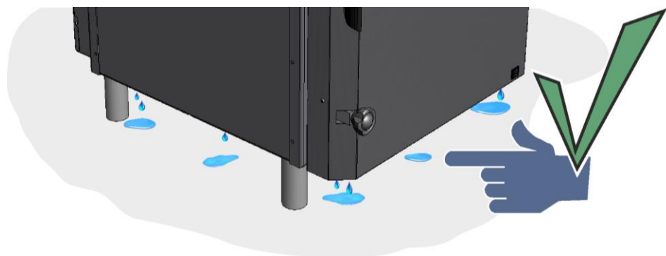
Fig. 66 Acumulaciones de condensado durante las primeras combustiones (figura análoga)
