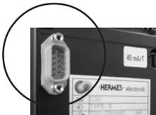
El controlador cuenta con una interfaz digital **RS 422** al dorso de la carcasa. Esta interfaz permite la conexión a un PC ordinario. Si se emplea el **Software de Regulación** correspondiente se pueden controlar y supervisar todas las opciones de programa confortablemente incluso de manera externa.
