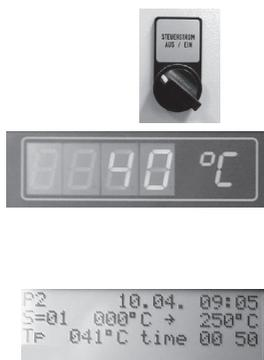
Контроллер готов к работе, если выключатель управляющего тока стоит на Вкл.
