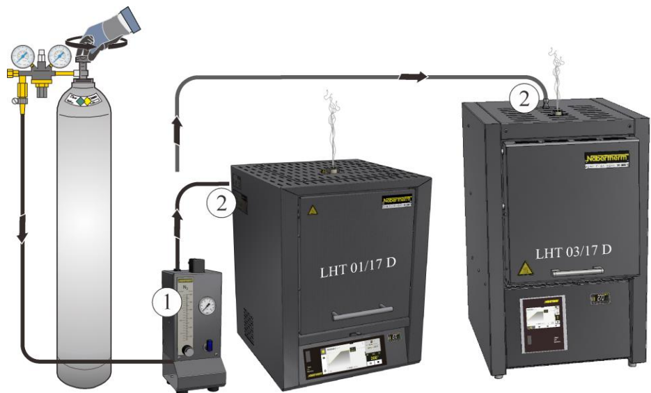
插图64： 与配气系统的连接（与插图相似）
