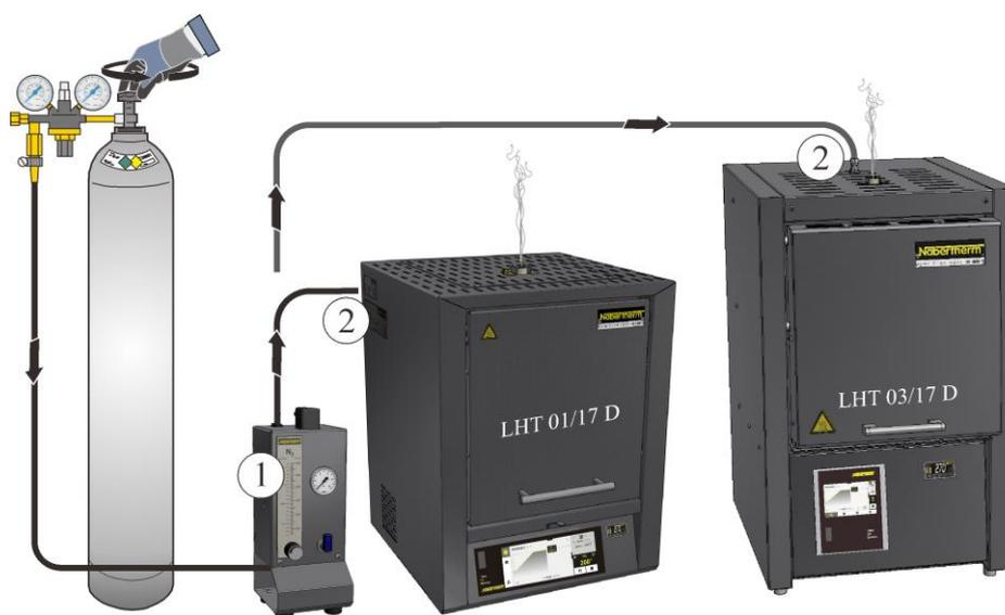
Fig. 64: Ligação ao sistema de gaseificação (semelhante à figura)
