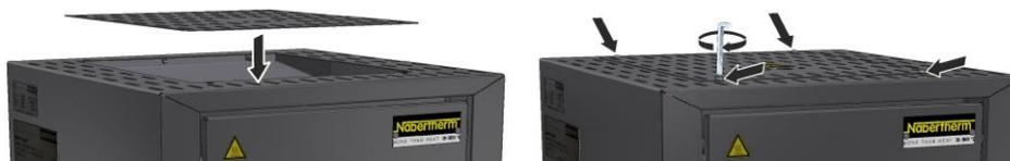
Fig. 51: Montar a cobertura Modelo LHT 01/17 D (semelhante à figura)
