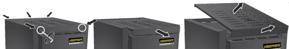
Fig. 37: Desmontar a cobertura Modelo LHT 03/17 D (semelhante à figura)
