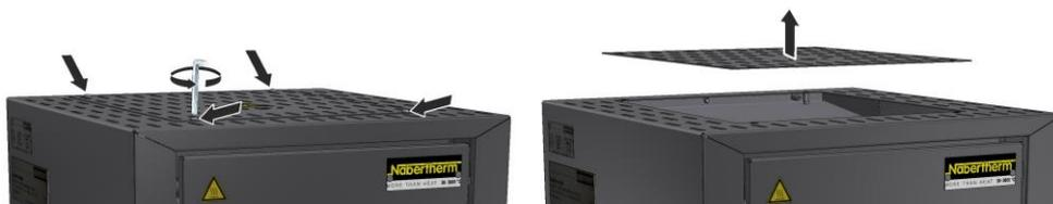
Fig. 44: Desmontar a cobertura Modelo LHT 01/17 D (semelhante à figura)
