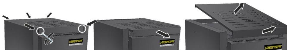
Fig. 45: Desmontar a cobertura Modelo LHT 03/17 D (semelhante à figura)
