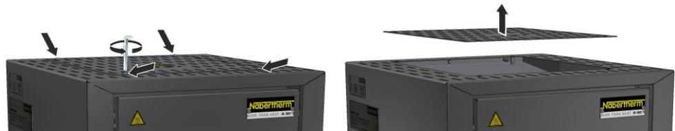
Fig. 36: Desmontar a cobertura Modelo LHT 01/17 D (semelhante à figura)
