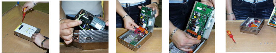
図 28: 制御機の交換
