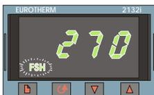
O limitador da selecção da temperatura Eurotherm 2132i monitora a temperatura da câmara do forno por meio de um circuito de medição independente. Se a temperatura da câmara do forno ultrapassar o valor ajustado (em regra  $T_{max} + 30 \text{ °C}/86 \text{ °F}$ ), para protecção do forno o aquecimento é desligado por meio de uma protecção de segurança – no limitador da selecção da temperatura pisca o alarme „FSH“.
