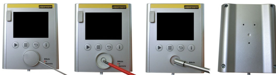
Att. 12: vadības bloka drukātās shēmas plates demontāža – 1. daļa (skatīt attēlu)
