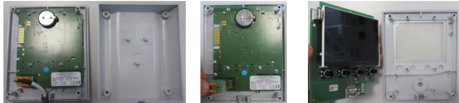
Att. 13: vadības bloka drukātās shēmas plates demontāža – 2. daļa (skatīt attēlu)
