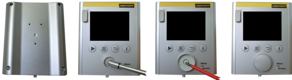
Att. 16: vadības bloka drukātās shēmas plates montāža – 3. daļa (skatīt attēlu)
