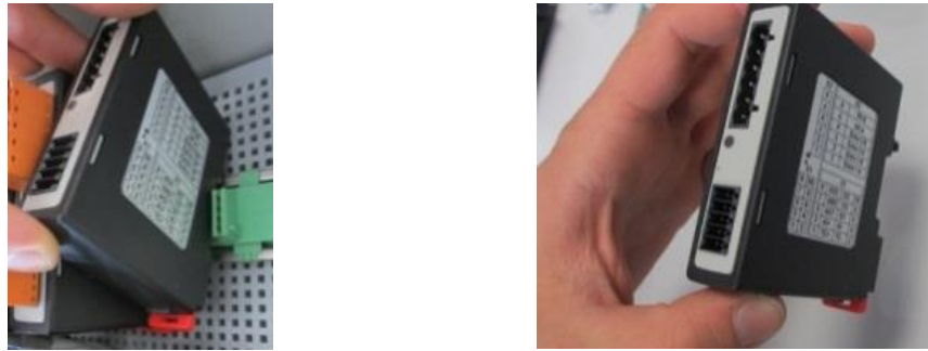
Fig. 18: Demontering av reglermodulerna – del 2 (liknande bilden)
