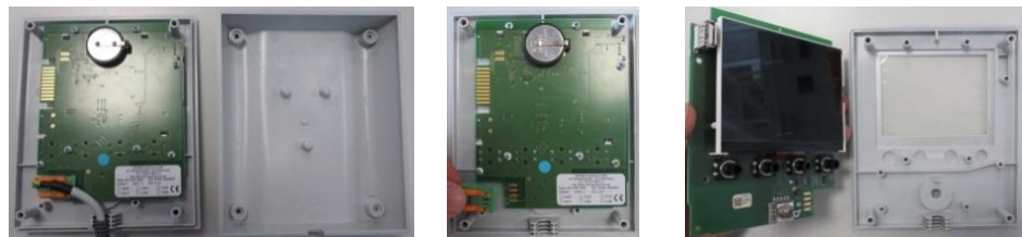
Fig. 13: Demontering av reglerenhetens kretskort – del 2 (liknande bilden)
