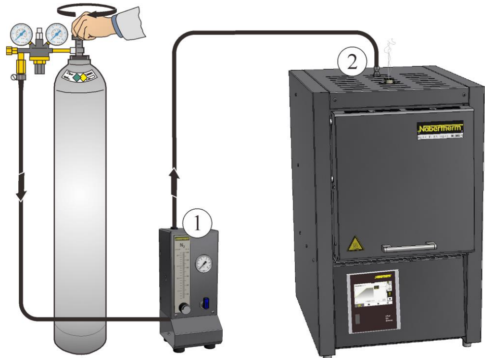
Afb. 58: Aansluiting van begassingssysteem (afbeelding vergelijkbaar)
