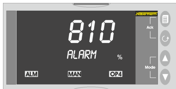
Fig. 60: Temperatuurkeuzebegrenzer 32h8i (afbeelding vergelijkbaar)
