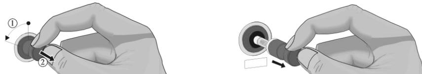
Fig. 55: Soltar y extraer el soporte del fusible (figura análoga)
