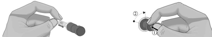
Fig. 57: Montar el fusible (figura análoga)
