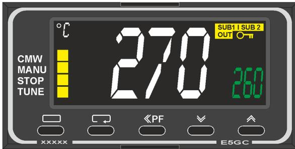
Limitador de selección de temperatura con temperatura de desconexión ajustable según DIN EN IEC 60519-1, como protección contra sobretensión para el horno y la mercancía
