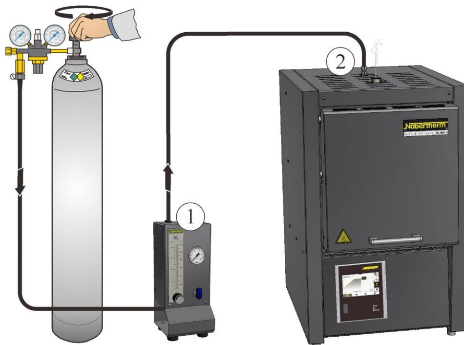
Fig. 58: Conexión con el sistema de gasificación (figura análoga)
