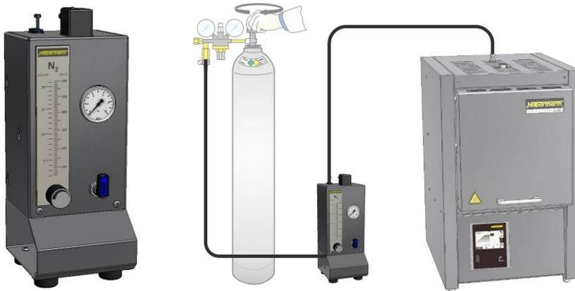
**Conexión de gas protector para gases protectores o de reacción no combustibles**
