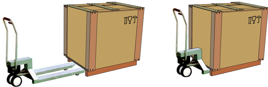
Изображение 10: Количката-нископовдигач се вкарва изцяло под палета
