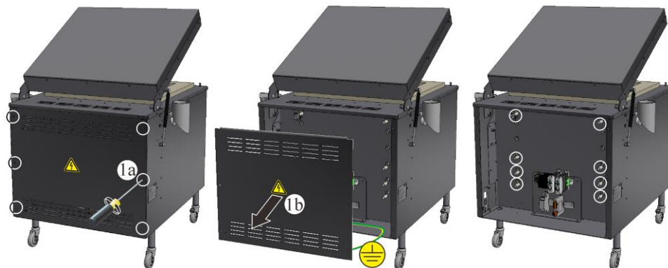
Изображение 75: Демонтиране на капака на електроразпределителното устройство от задната страна на пещта (изображението е илюстративно)
