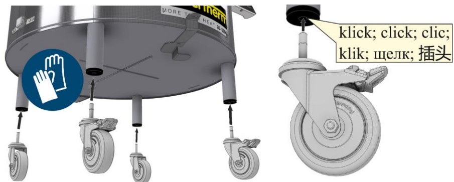
Εικ. 15: Συναρμολόγηση των κυλίνδρων μεταφοράς (παρόμοια με την εικόνα)
