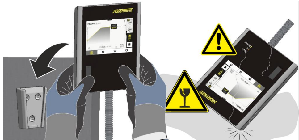
Εικ. 21: Τοποθετήστε τον ελεγκτή στο στήριγμα που βρίσκεται στον κλίβανο (ανάλογα με το μοντέλο)
