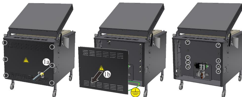
Εικ. 75: Αποσυναρμολόγηση του καλύμματος υποσταθμού από την πίσω πλευρά του κλιβάνου (παρόμοια με την εικόνα)
