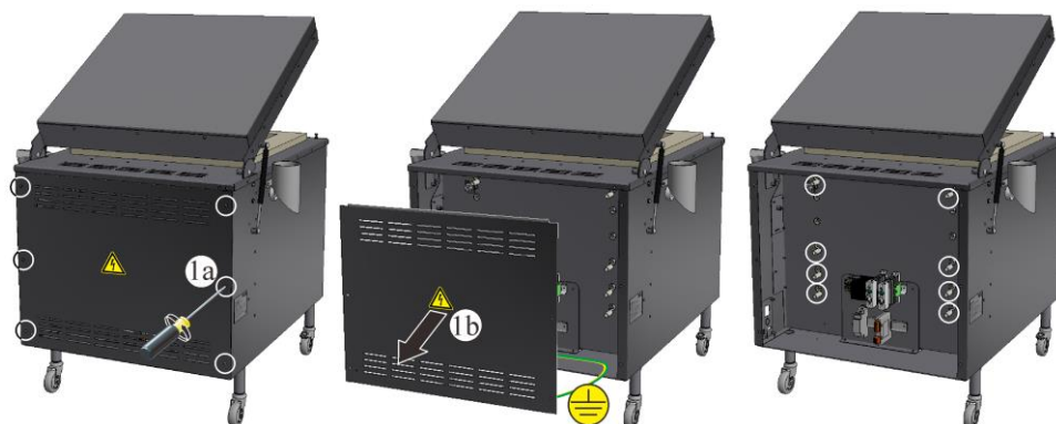
Slika 75: Demontaža pokrova stikalne naprave s hrbtne strani peči (podobno kot na sliki)
